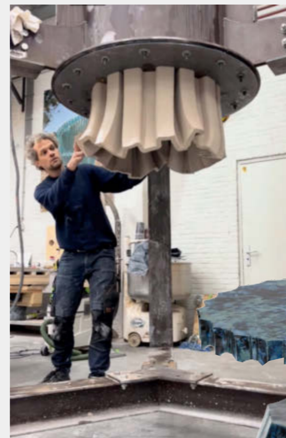
Ziegelsitz: Der „Brick“-Chair spielt auf traditionelle niederländische Backsteine an. Sein Ton hat eine fettige Textur, der sich präzise formen lässt. Floris Wubben (links) überprüft und lenkt den Ton beim Austreten aus dem Extruder. Der „Fortress Dining Table“ hat 125 Zentimeter Durchmesser und ist auch ohne Unterkonstruktion stabil
